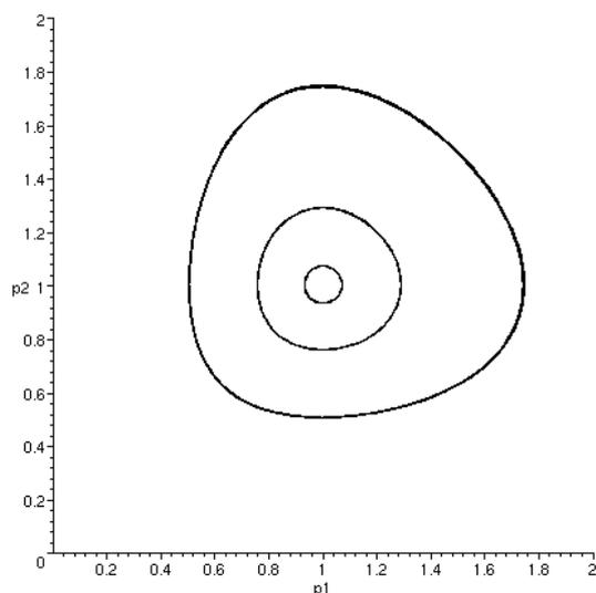
Figura 12.1: A evolução do sistema de Lotka-Volterra para três condições iniciais distintas. O eixo horizontal é a população  $p_1$  e o vertical  $p_2$ . Note que a evolução se dá em ciclos periódicos fechados, uma característica especial do sistema de Lotka-Volterra.
